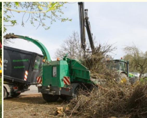
20-mal höher als bei Kleinhäckslern. Das Verfahren ist somit sehr zeitsparend. Andererseits kann das Häckseln mit diesen großen Maschinen nur auf gut befahrbaren und befestigten Wegen bzw. Plätzen erfolgen. Das Schnittgut muss also von den Grundstücken zum Sammelplatz transportiert werden.
